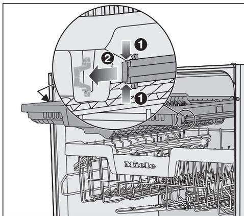
■ Сожмите предохранительные скобы направляющих по обеим сторонам выдвижного поддона для столовых приборов **1** и одновременно снимите предохранительные скобы **2**.
