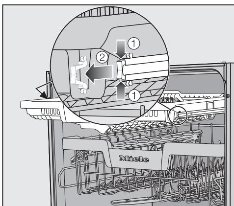
■ Сожмите ① предохранительные скобы направляющих по обеим сторонам выдвижного поддона для столовых приборов и снимите предохранительные скобы ②.
