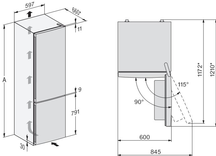
\* Размер с установленными проставками. Если проставки не используются, то глубина прибора уменьшается примерно на 22 мм.
