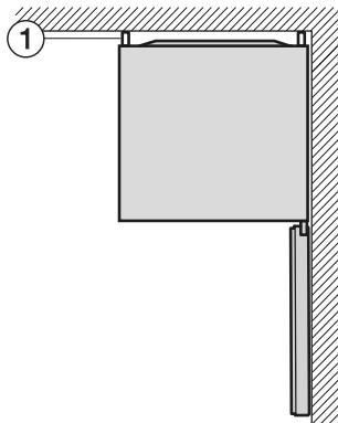
Проставки ① с обратной стороны прибора обеспечивают надлежащий отвод влаги.
